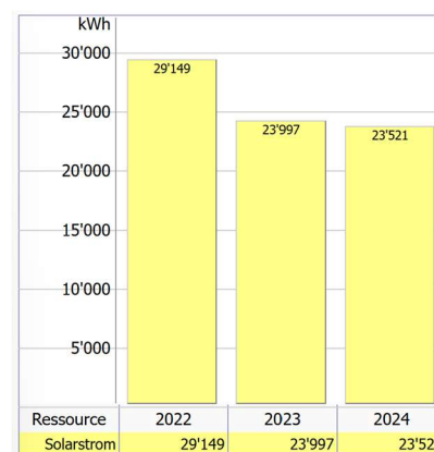
Abbildung 13: Stromproduktion der PV-Anlage
